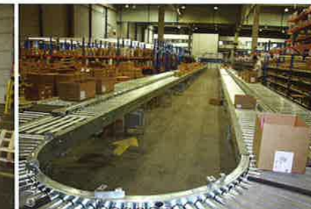
Le convoyeur modulaire et « intelligent » de Boa Concept. N'est en mouvement que le module sur lequel se trouve un colis. D'où une solution particulièrement silencieuse.
