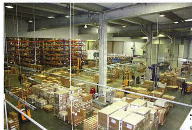
L'entrepôt avec, au centre, le convoyeur de Boa Concept qui autorise plus de polyvalence de la part des opérateurs. Ceux-ci font du picking et de la préparation de colis, rangent les produits en stock, valident des transferts.
