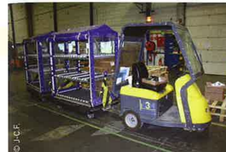
Le petit train interbâtiments : son chauffeur assure la ramasse dans les différentes gares en production et, au retour, oriente les cartons vers la réserve ou les dépose directement sur le convoyeur.
