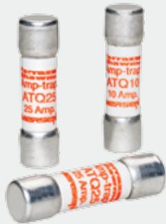
Les fusibles Midget Amp-Trap® temporisés ATQ avec une tension de 500 volts CA et 42 calibres allant de 1/10 à 30A. Ils sont un excellent choix pour une protection additionnelle des circuits jusqu'à 30A où les courants de faute sont inférieurs à 10,000A. (Ne pas utiliser sur les circuits de distribution).
